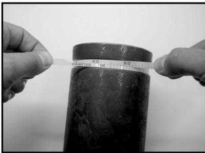
Messen des Nutgrundes unter Verwendung eines Maßbandes zur Messung von Durchmessern, eines Umfangmaßbandes oder eines Messschiebers, mit dem bei 0° und bei 90° am Umfang gemessen wird, um sicherzustellen, dass der Nutgrund-Durchmesser C bzw. der Nutgrund-Umfang innerhalb der in Tabelle 2, Spalte 5 angegebenen Toleranzen liegt.
