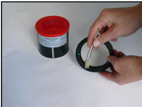
**Um ein Einklemmen der Dichtung zu verhindern, müssen die Außenseite der Dichtung und die Innenseiten der Kupplungshalbschalen sowie auch die Dichtungslippe innen und die Außenseiten der Rohrenden leicht geschmiert werden.**
