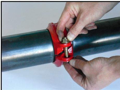
Setzen Sie die verbleibende Schraube in die Schraubenlöcher ein und ziehen Sie die Mutter handfest an.
