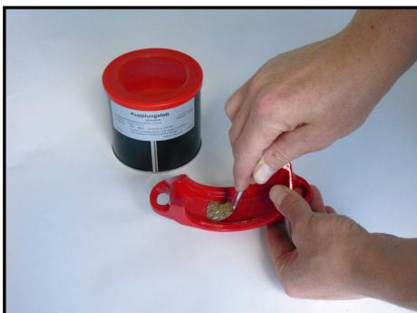
Tragen Sie auch auf die Innenseiten der beiden Halbschalen der Kupplung je eine dünne Schicht Schmiermittel auf.
