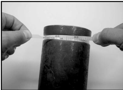
Messen des Nutgrundes unter Verwendung eines Maßbandes zur Messung von Durchmessern, eines Umfangmaßbandes oder eines Messschiebers, mit dem bei 0° und bei 90° am Umfang gemessen wird, um sicherzustellen, dass der Nutgrund-Durchmesser C bzw. der Nutgrund-Umfang innerhalb der in Tabelle 1, Spalte 5 angegebenen Toleranzen liegt.
